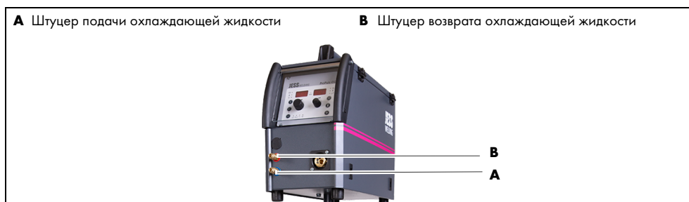
Рис. 8 Подсоединение шлангов подачи охлаждающей жидкости к механизму подачи проволоки
