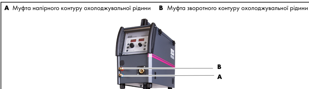
Рис. 8 Підключення шлангів охолоджувальної рідини до пристрою подачі дроту
