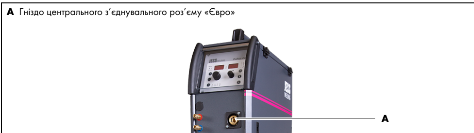
Рис. 7 Під'єднання шлангового пакета зварювального пальника
